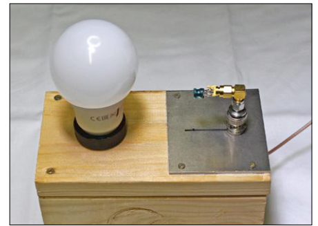
Figuur 22. Een kleine spoel als magnetische veldsensor op 5 cm afstand van de lamp.
